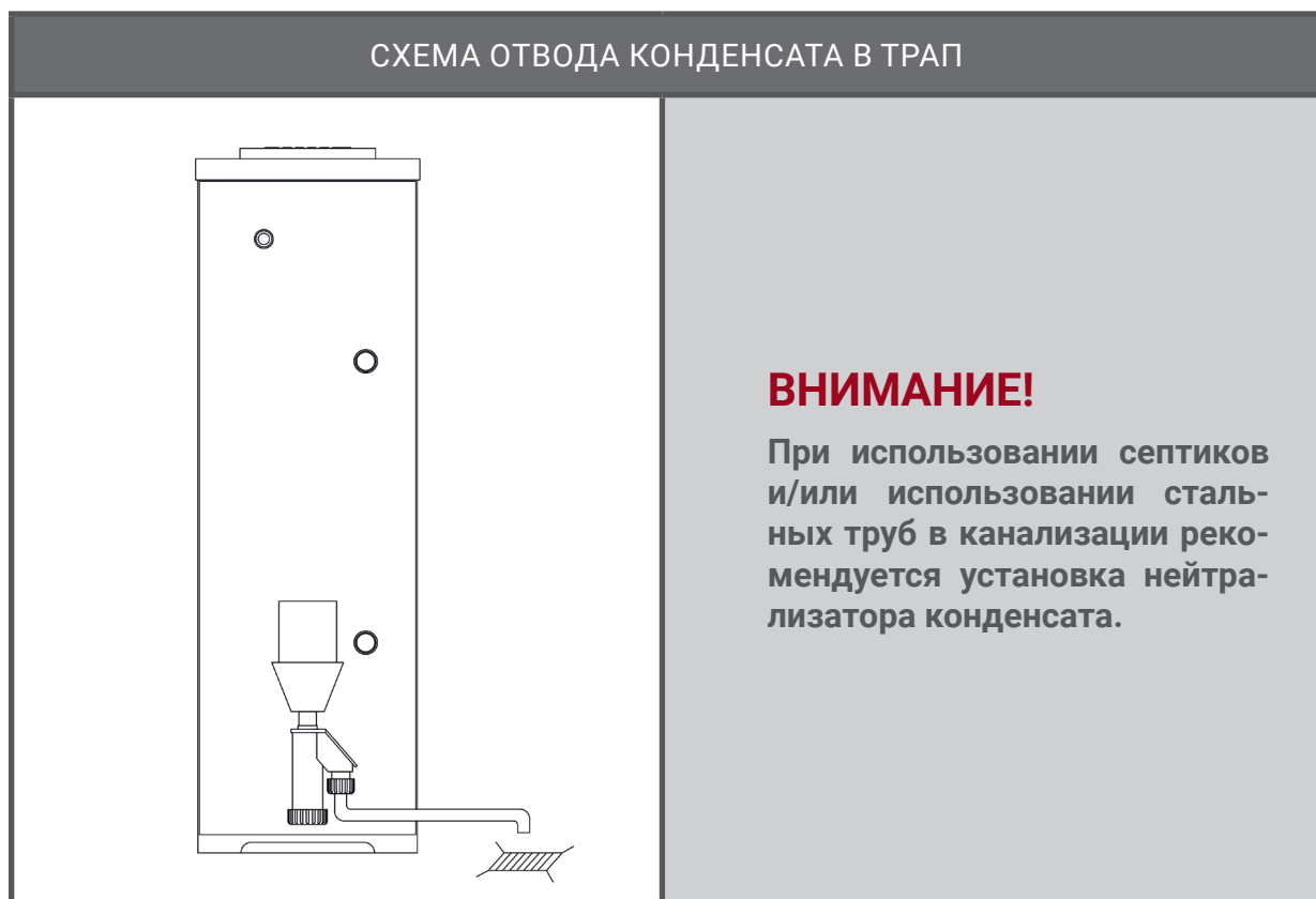
Рисунок 6 а. Схема отвода конденсата в трап
